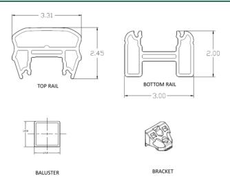
FIGURE 2—TREX® TRANSCEND® SERIES RAILING COMPONENTS
