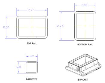
FIGURE 4—TREX® SELECT® SERIES RAILING COMPONENTS
